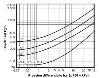
Lors du dimensionnement du purgeur, il est important de s'assurer que le bon modèle est sélectionné. Cela permettra un fonctionnement adéquat et une durée de vie maximale. Pour la purge de ligne et les applications de traçage, la version LC devra être choisie quelque soit la dimension de la tuyauterie.
