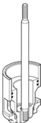
**Clapet équilibré parabolique**
