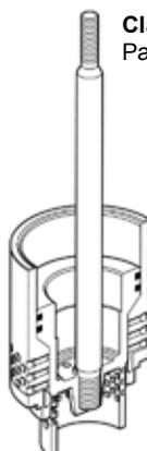
**Clapet équilibré anti-cavitation**
