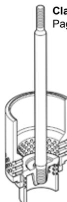
**Clapet non-équilibré anti-cavitation**
