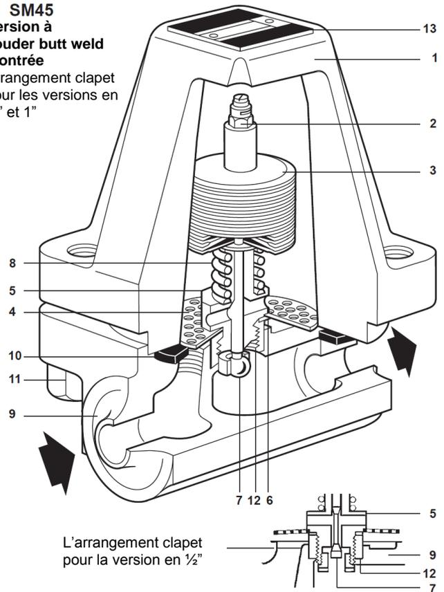
L'arrangement clapet pour la version en 1/2"
