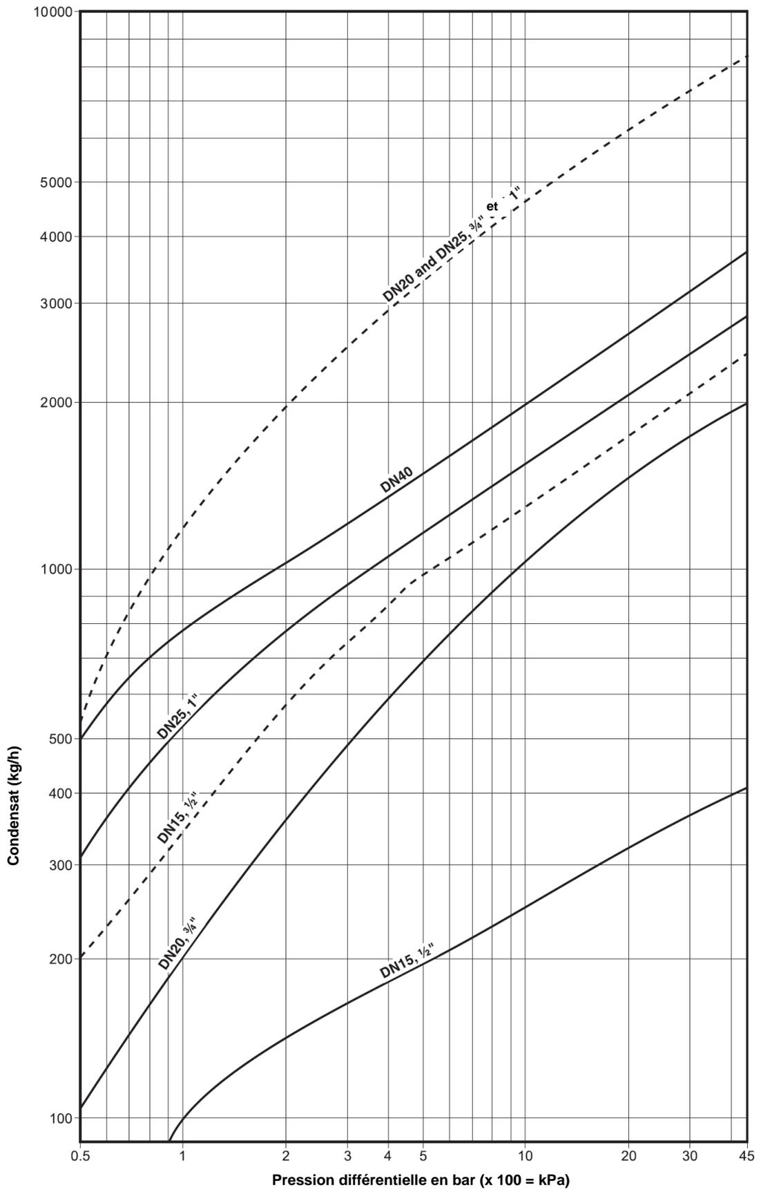
Capacité de l'eau chaude ——— Capacité de l'eau froide - - -
