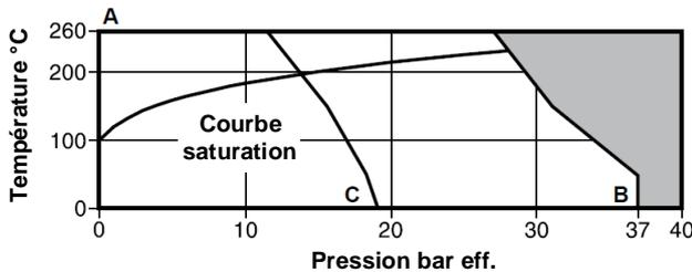
La vanne ne doit pas être utilisée dans cette zone
