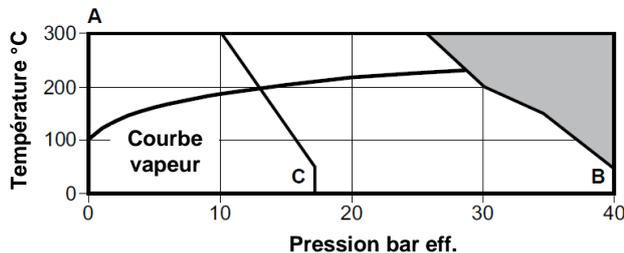
La vanne ne doit pas être utilisée dans cette zone
