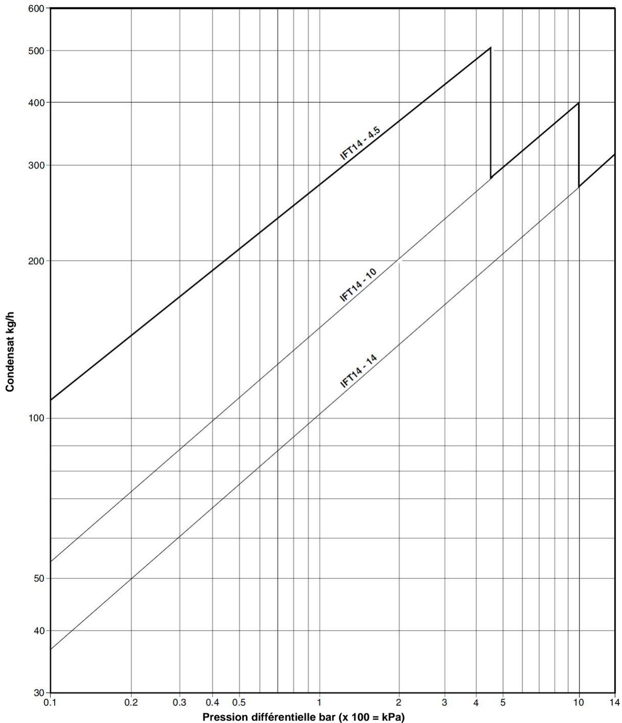
**Surplus de capacité à cause de l'évent thermostatique (TV) au démarrage à froid.**
