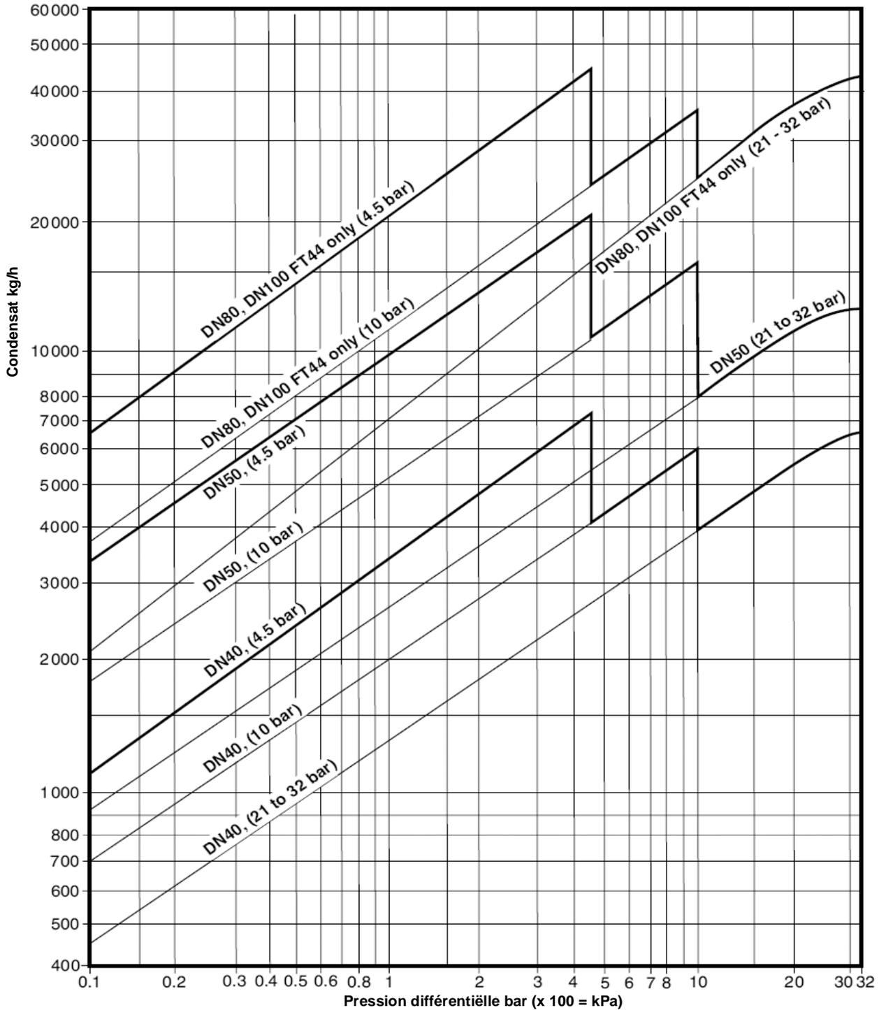
**Surplus de capacité à cause de l'évent thermostatique au démarrage à froid.**
