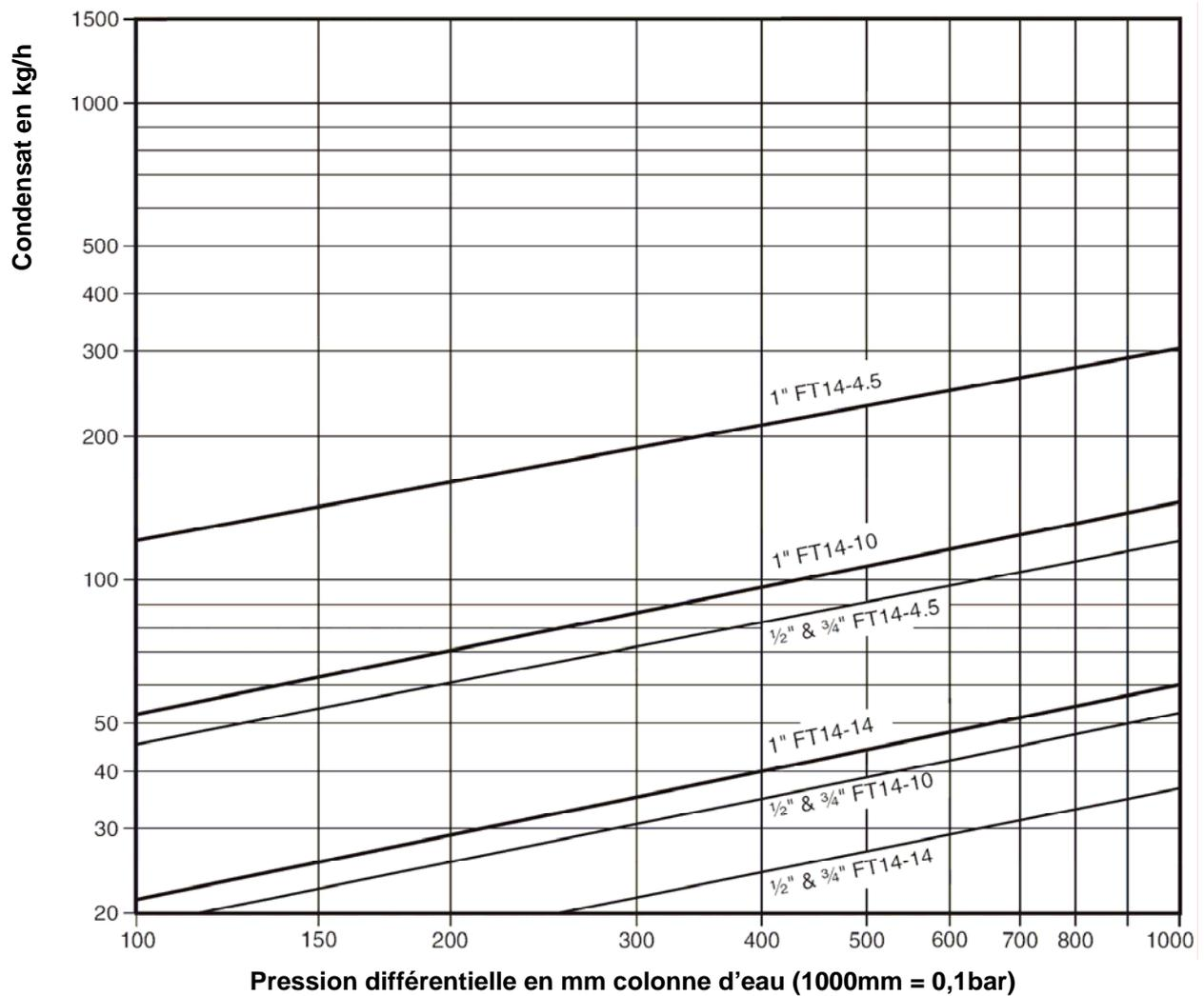
**Note: pour pression différentielle au-dessus 1000mm colonne d'eau:
