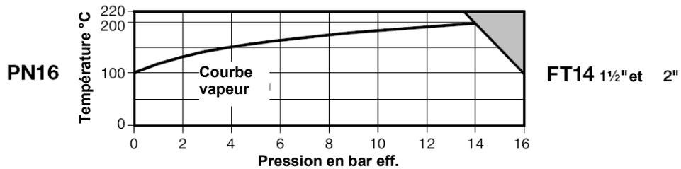
Ce purgeur ne doit pas être utilisé dans la zone ombrée.
