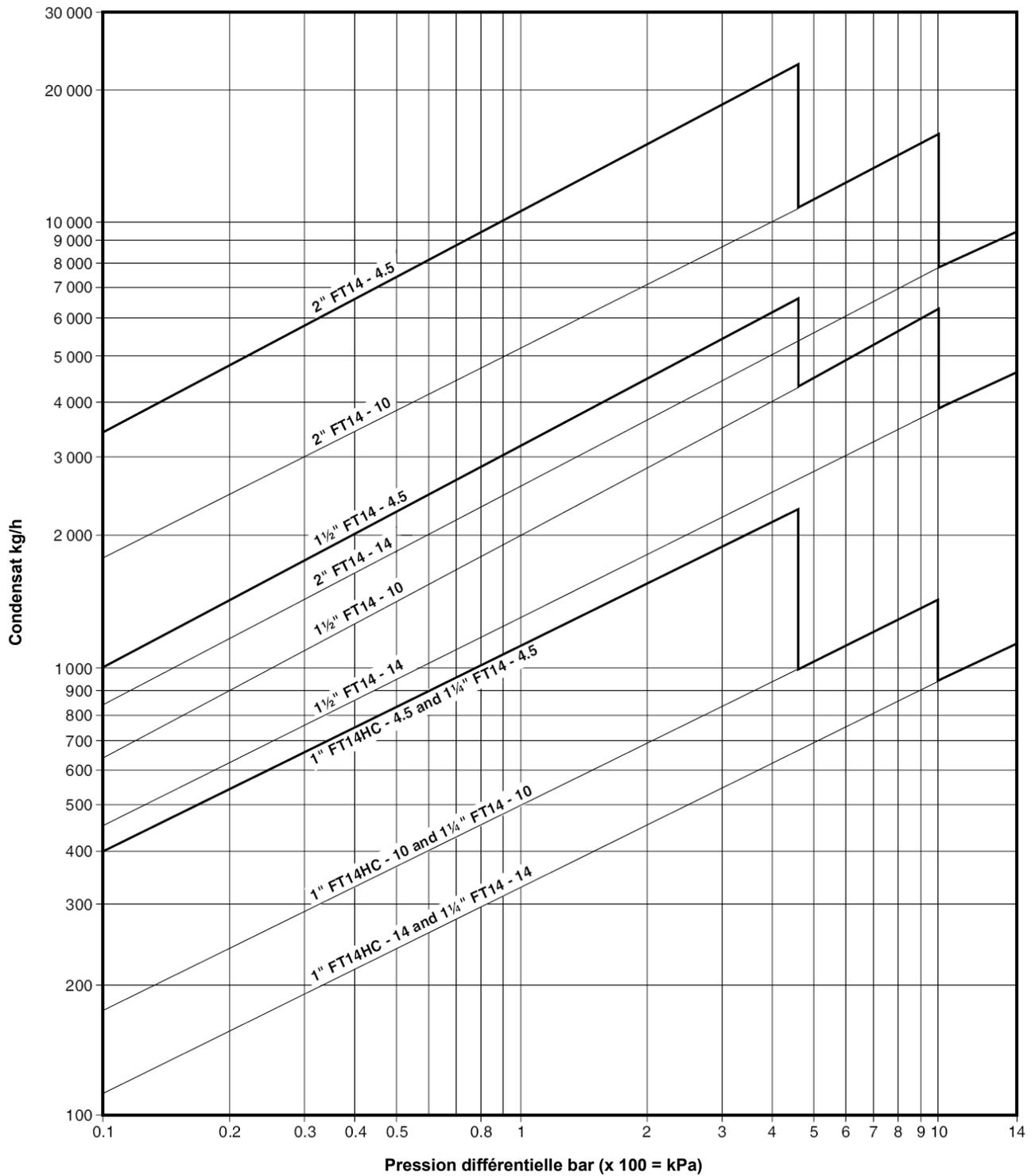
Capacité supplémentaire via purgeur d'air lors d'un démarrage
