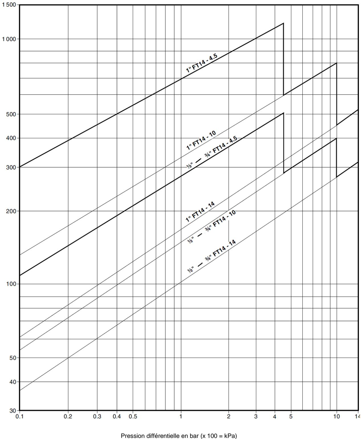
**Remarque:** les capacités mentionnées ont été mesurées à la température de saturation. Pour condensat sous la température de saturation (ex. au démarrage), la capacité du purgeur thermostatique est encore ajoutée à ce chiffre: approx. 50% (FT14-4,5) jusqu'à 100% (FT14-10 et FT14-14 bar).
