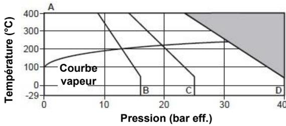
Le produit ne doit pas être utilisé dans la zone ombrée.
