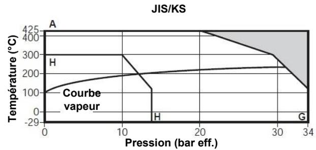
Le produit ne doit pas être utilisé dans la zone ombrée..
