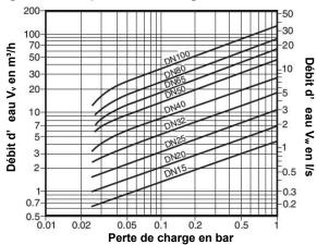
Les pertes de charge données sont valables pour des clapets de non-retour à disque avec ressort dans un écoulement horizontal. Lors d'un écoulement vertical, il peut y avoir de faibles différences lors de l'ouverture partielle du clapet.
