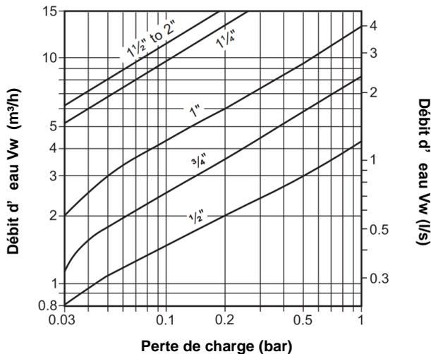
L'abaque donne la perte de charge avec clapet ouverte à 20°C. Les pertes de charge données sont valables pour des clapets de non-retour à disque avec ressort dans un écoulement horizontal. Lors d'un écoulement vertical, il peut y avoir de faibles différences lors de l'ouverture partielle du clapet.
