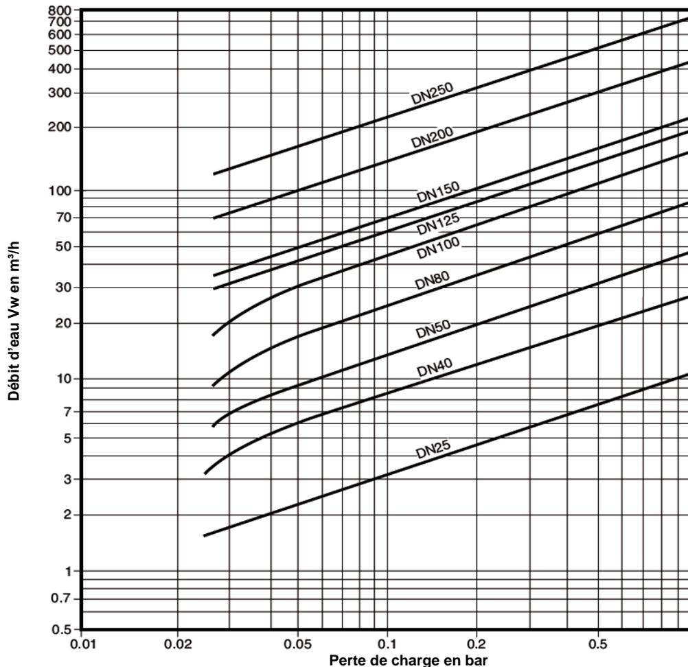
Pertes de charge pour un clapet ouvert à 20°C. Les pertes de charge données sont valables pour des clapets de non-retour à disque avec ressort dans un écoulement horizontal. Lors d'un écoulement vertical, il peut y avoir de faibles différences lors de l'ouverture partielle du clapet.
