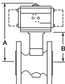
\*Nota : Les dimensions A et B représentent les tailles maximales (mm) pour l'actionneur de plus grand DN recommandé avec chaque robinet. \*\*Nota : 1/2" et 3/4" uniquement pour M21i
