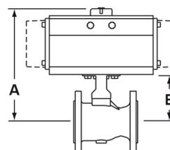
\*Nota : Les dimensions A et B représentent les tailles maximales (mm) pour l'actionneur de plus grand DN recommandé avec chaque robinet.
