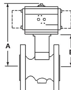
\*Nota : Les dimensions A et B représentent les tailles maximales (mm) pour l'actionneur de plus grand DN recommandé avec chaque robinet.
