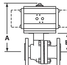
\*Nota : Les dimensions A et B représentent les tailles maximales (mm) pour l'actionneur de plus grand DN recommandé avec chaque robinet.
