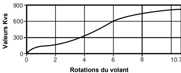
**Clapet standard typique pour BSA1, BSA2 et BSA3 – clapet plat**
