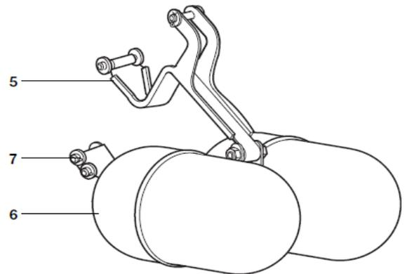
**F Ensemble soupape de purge et clapet de sortie**
