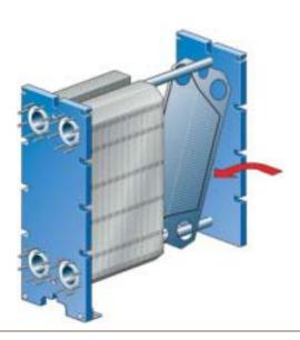
Comprimer l'ensemble des plaques. Le serrage se déroule en deux temps, voir les figures ci-dessous. Veiller toujours à ce que le bâti fixe et le plateau de serrage mobile soient parallèles.
