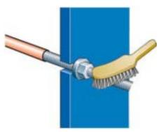
Fixer les joints sur les plaques ou vérifier que tous les joint sont correctement fixés.
