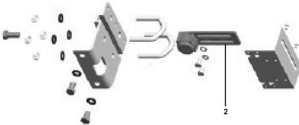
Fig. 24 Kit de montage de la colonnette pour un servomoteur linéaire
