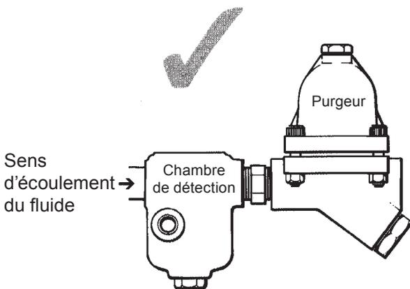
Fig. 1 - Installation recommandée
