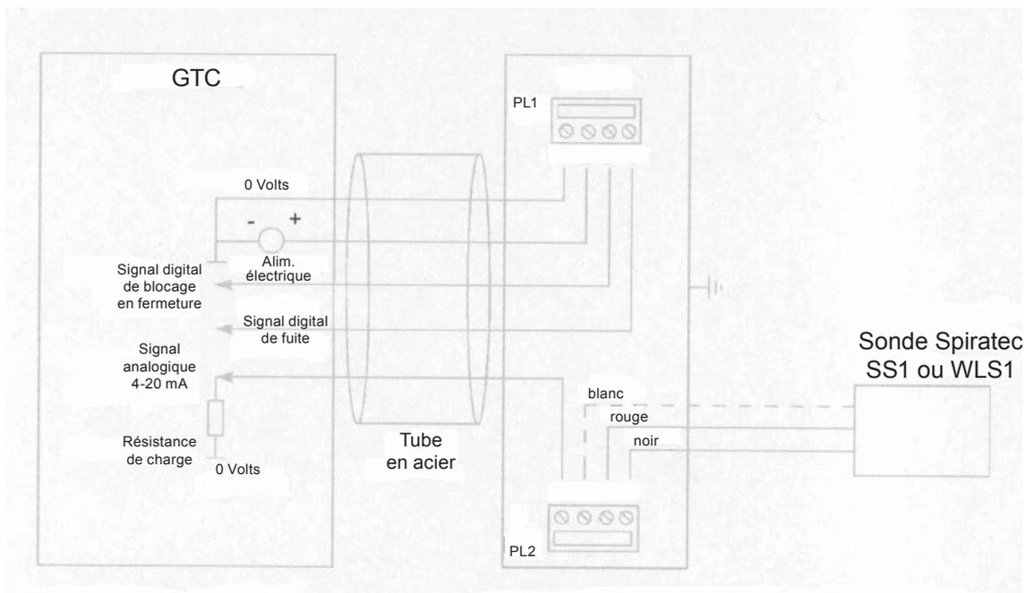
Fig. 6 Schéma de câblage
