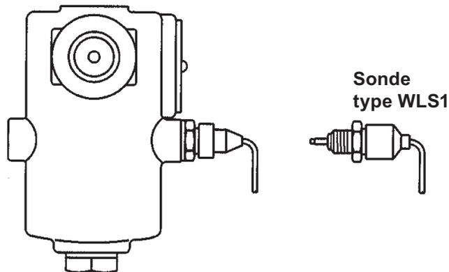
Fig. 4 - Chambre de détection ou purgeur avec chambre incorporée (non représenté) équipée d'une sonde de détection de fuite vapeur et de retenue anormale d'eau condensée type WLS1.
