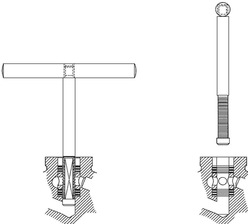
Fig. 4 Vue représentant l'intérieur du robinet et l'extracteur
