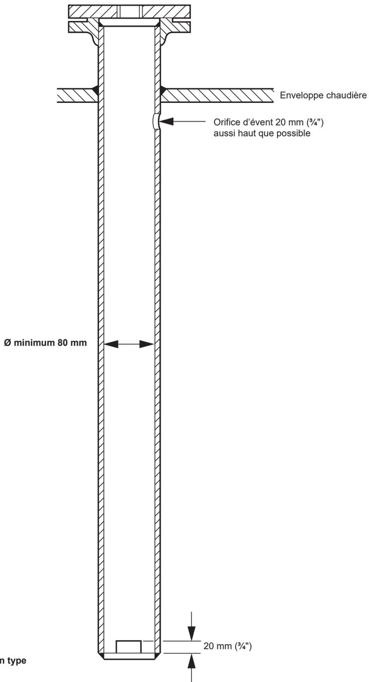
Fig. 3 Tube de protection type
