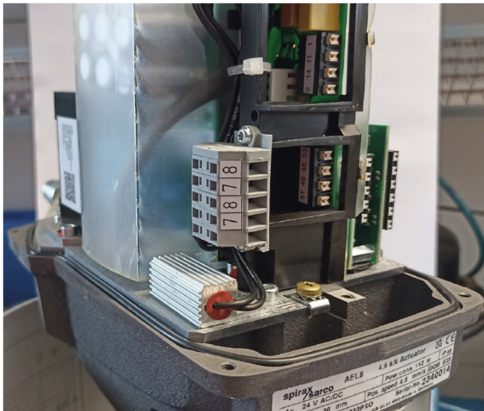
Fig. 6 - Orientation du chauffage
