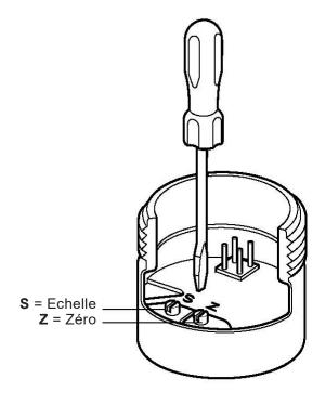
Fig. 3 - Étalonnage - position de l'échelle et du zéro
