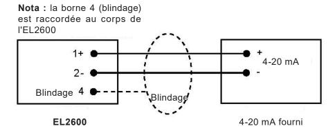
Fig. 2 Détails sur le câblage
