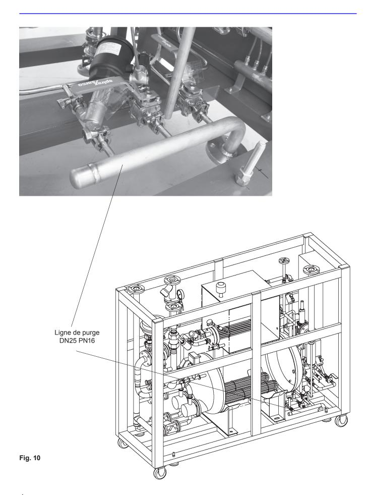
▲ Nota : le raccordement de la ligne de purge doit être conforme aux règlementations locales, ou les exigences de l'installateur.
