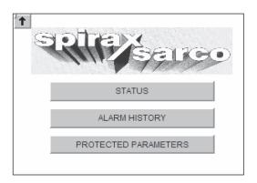
**12.** Presser sur "**Status**" comme indiqué ci-dessous en s'assurant que les status générateur et réservoir indiquent "stopped" (voir photo), réécrire "tank stopped" sur le bouton "touchscreen".
