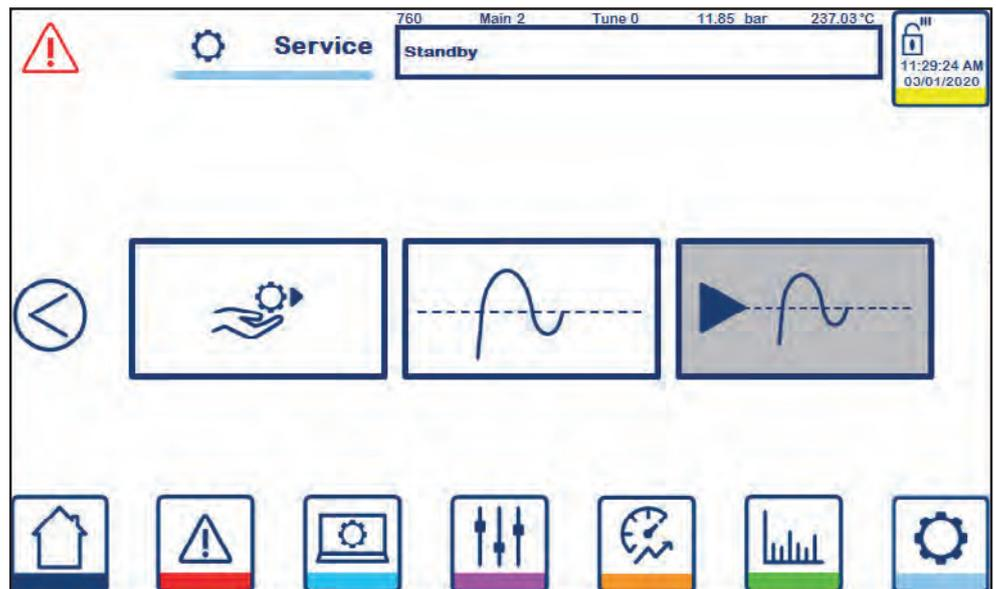
Service (760) permet aux utilisateurs de commencer la séquence d'entretien  $\pm$ , d'entrer en mode de réglage PID (disponible uniquement en mode veille) ou en mode de réglage en cours (disponible uniquement en mode Exécution).
