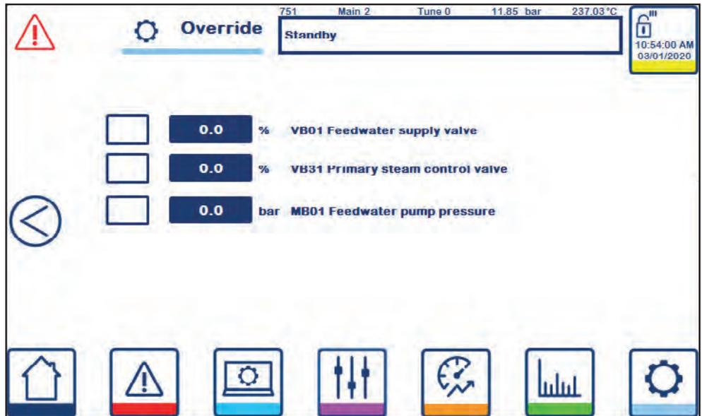
Le forçage analogique (751) active et déplace les vannes de régulation dans une position spécifique. (Disponible uniquement en mode veille)
