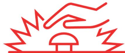
Lorsque l'arrêt d'urgence est déclenché, l'état du CSG-FB passe directement en 'Arrêt d'urgence', remplaçant tout état de fonctionnement précédent. De plus, tous les robinets d'isolement automatisés sont réinitialisés, les vannes de régulation sont fermées et la pompe à eau (le cas échéant) est désactivée.
