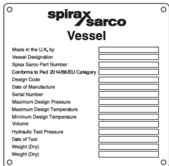
Fig . 1 - Détails de la plaque-firme du ballon-éclateur de purge.
