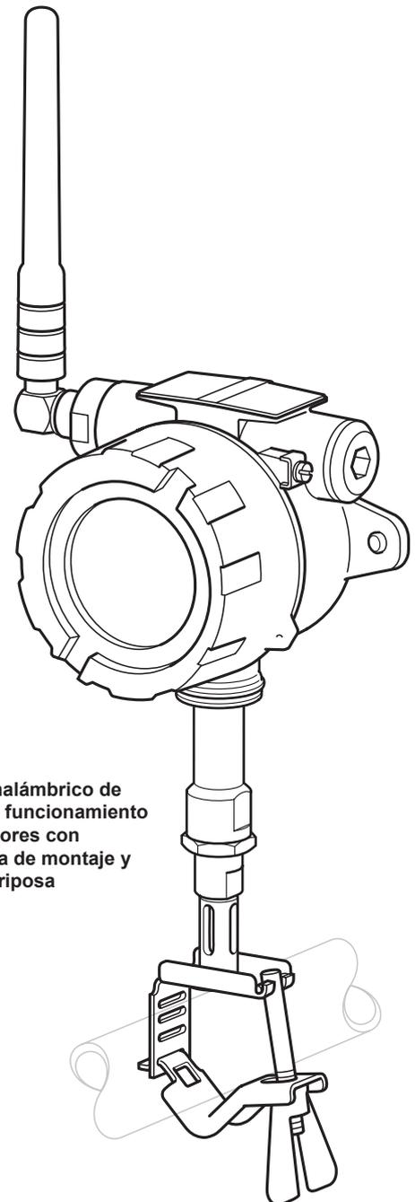
Sistema inalámbrico de control de funcionamiento de purgadores con abrazadera de montaje y tuerca mariposa
