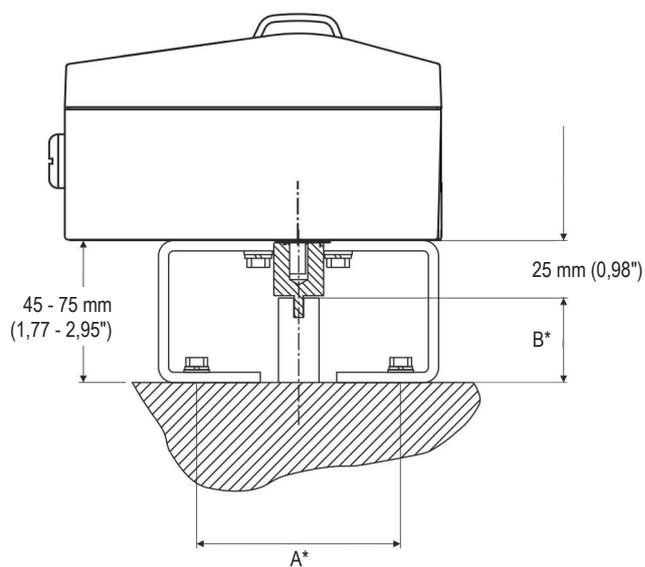
\* Las dimensiones A y B dependen del actuador rotativo
