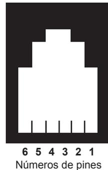
Fig. 25 Conector RJ11
