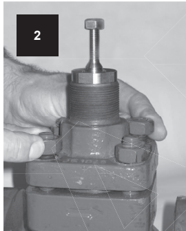
Apretar a mano las tuercas de la tapa secuencialmente en diagonal
