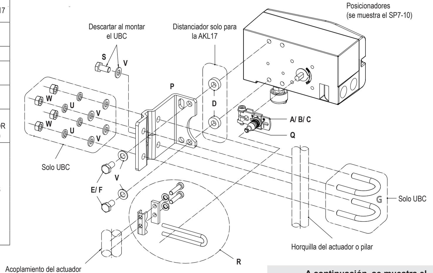
**A continuación, se muestra el montaje del kit de montaje Rotativo**
