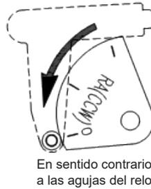
**Fig. 19** Instalación de la leva (RA)
