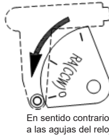
Fig. 19 Instalación de la leva (RA)
