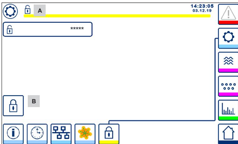
Fig. 37 Desbloqueo de la protección de seguridad
