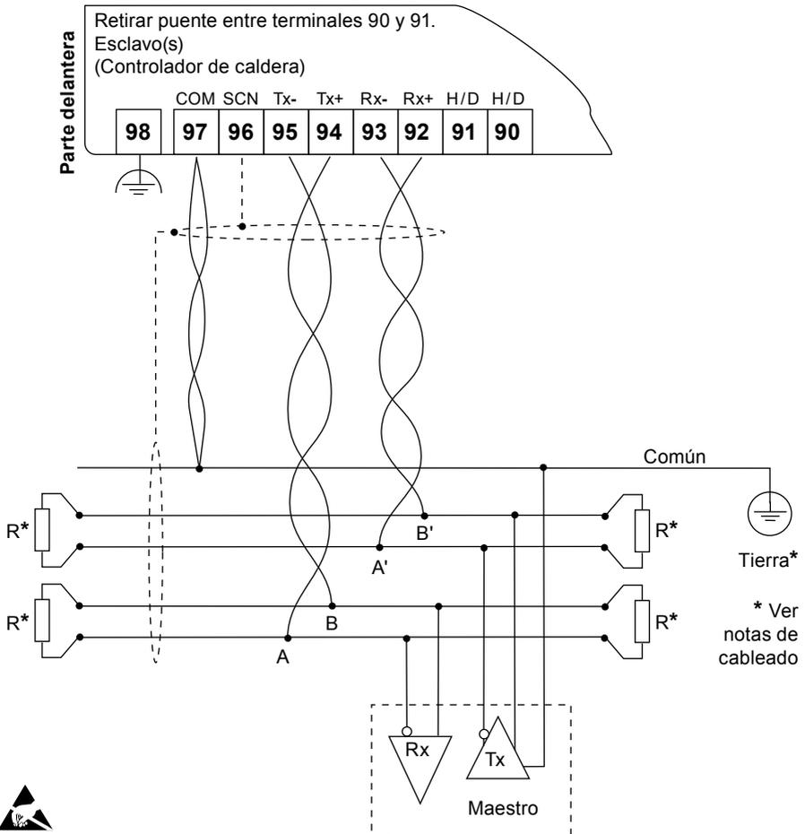
Fig. 21 Circuito RS485/Modbus de cuatro hilos (visto desde arriba)
