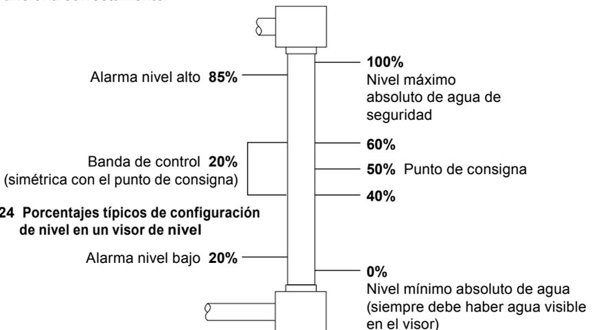
**Fig. 24** Porcentajes típicos de configuración de nivel en un visor de nivel
