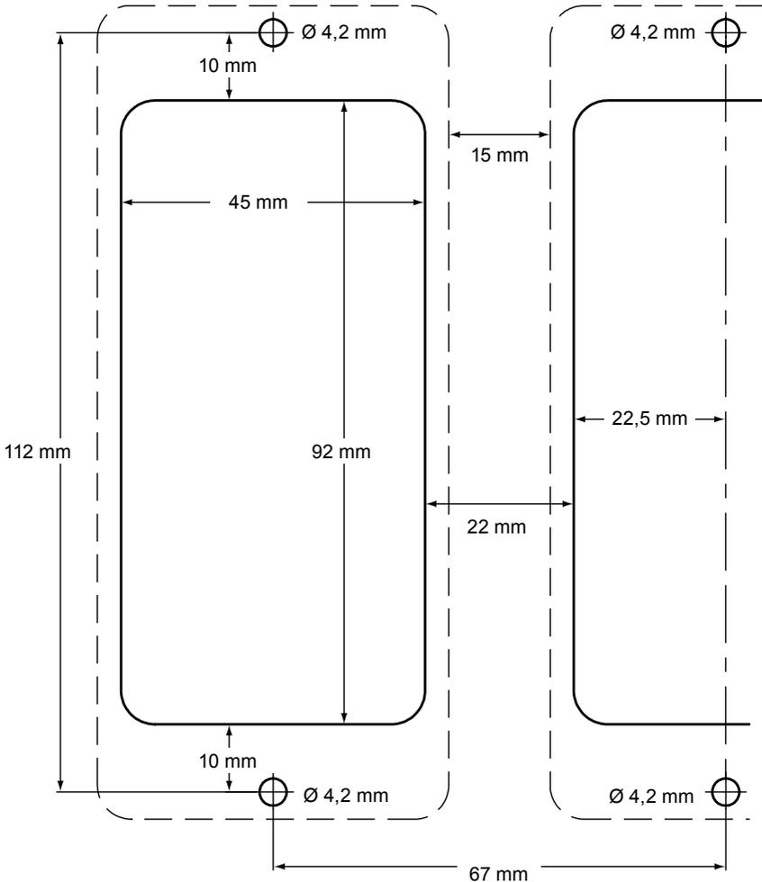
**Fig. 12 Plantilla para montar en chasis o recorte de panel**
