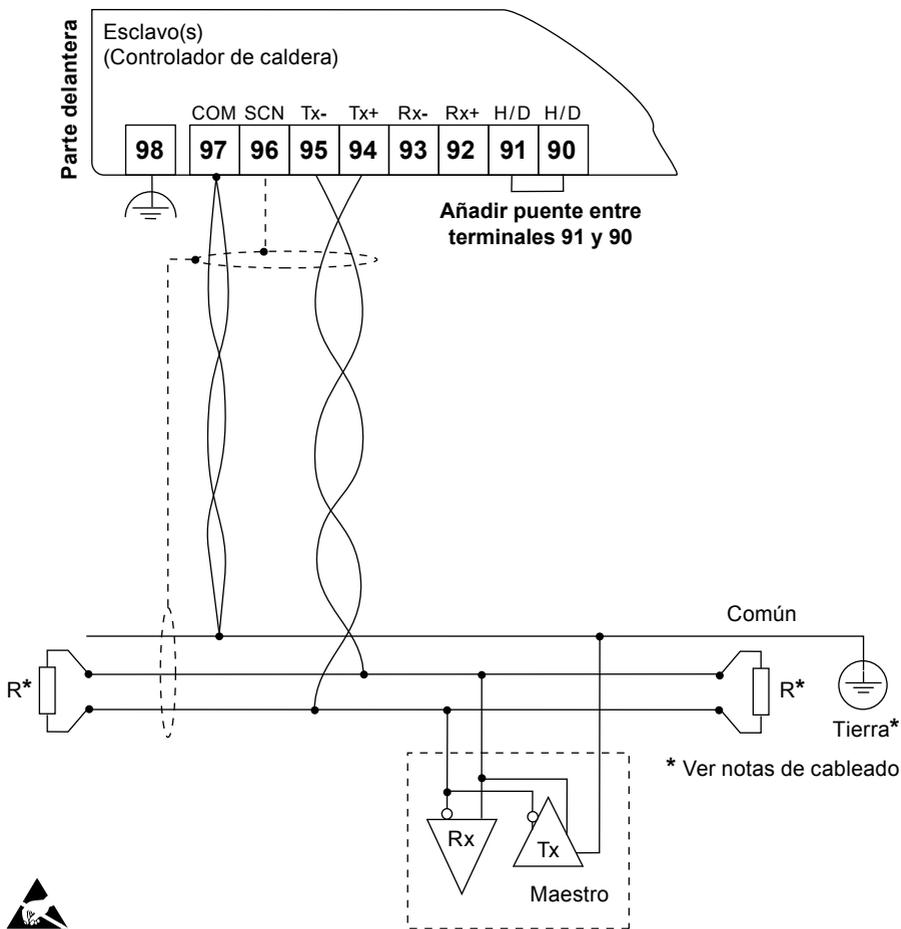
**Fig. 22 Circuito RS485/Modbus de dos hilos (visto desde arriba)**
