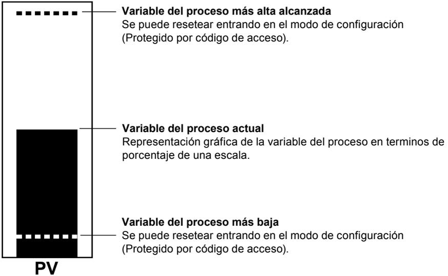
Fig. 3 Definición del gráfico de barras PV (nivel %)
