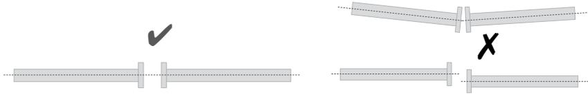
Instalación o montaje de productos después del mantenimiento:
