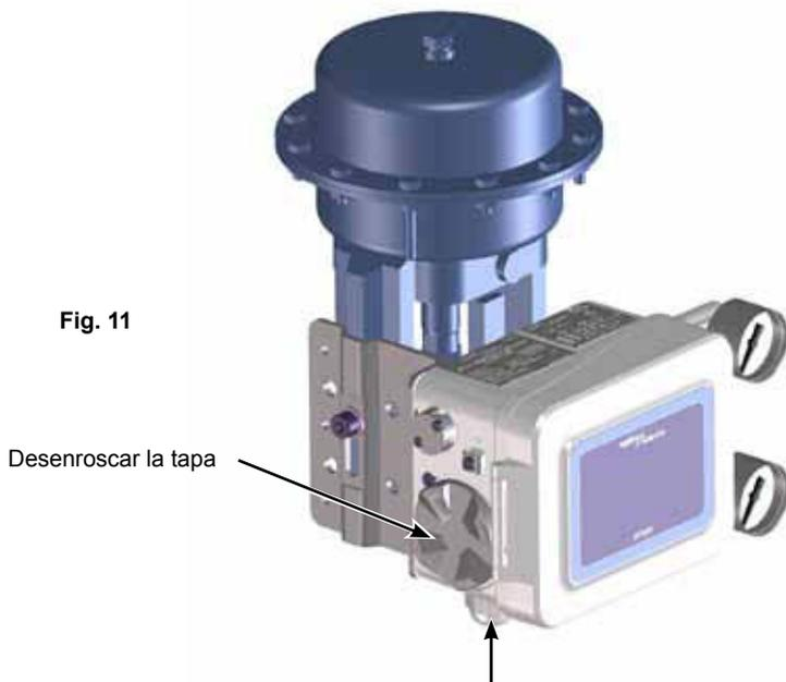
Introducir el cable eléctrico (4 a 20 mA), conectar a los terminales correspondientes y enroscar la tapa.
