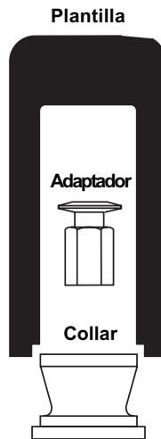
Fig. 5 Kit de conexión del actuador con válvulas LE y KE. Incluye collar, adaptador y plantilla de cartón.
