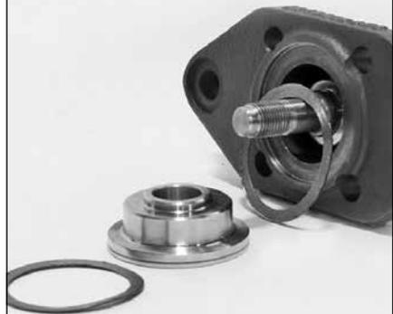
Con cuidado colocar una junta nueva del interior de la tapa seguido del plato guía del vástago.
