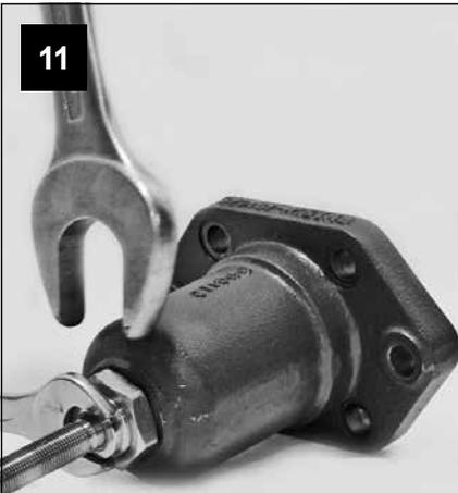
Con una llave fija de 24 mm E/C sujetar los dos planos en el fuelle y apretar la tuerca sujeción a un par de apriete de 60 - 65 Nm con una llave fija de 30 mm E/C para tamaños DN15 y DN20 y con una llave fija de 36 mm E/C para tamaños DN25 y DN32.
