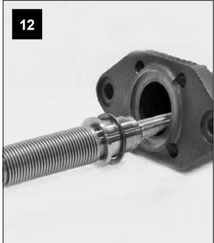
Montar la nueva junta en el vástago del fuelle nuevo.
