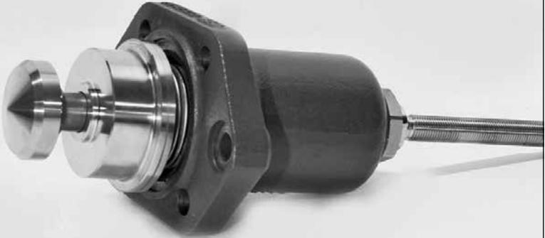
Colocar el plato guía y enroscar el conjunto obturador en el vástago (a mano). Asegurar que el plato guía se coloca sobre el conjunto obturador.
