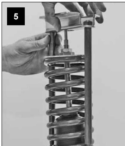
Colocar el plato montaje del actuador en la válvula y centrar los agujeros de montaje.
