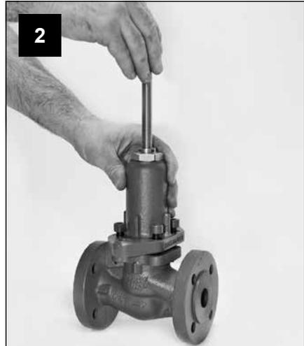
Montar los tornillos y dejar un poco de espacio. Subir y bajar el vástago mientras se sujeta firmemente la tapa (para asegurar que el obturador y asiento estén alineados).
