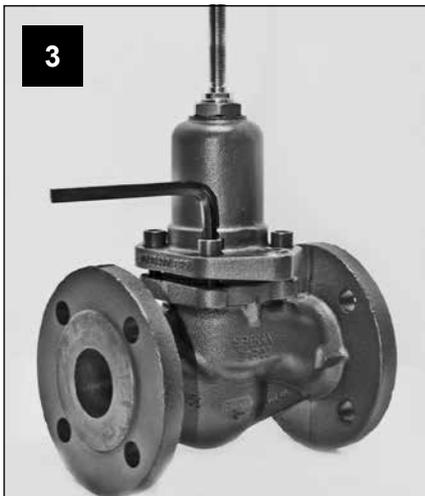
Apretar los cuatro tornillos de la tapa usando una llave de tubo de 8 mm siguiendo la secuencia mostrada en la Fig. 7 a un par de apriete de 28 - 32 N m.
