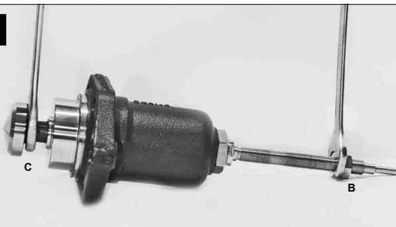
Volver a montar el plato guía y enroscar a mano el nuevo conjunto obturador. Apretar sujetando la tuerca **B** con una llave fija de 22 mm E/C y apretar la tuerca adaptador del obturador **C** con una llave fija de 24 mm E/C a un par de apriete de 15 +1 N m para tamaños DN15 a DN20 y 20 +2 N m para tamaños DN25 a DN2100.
