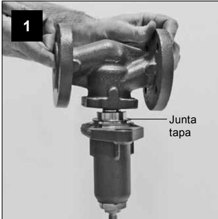
Colocar boca abajo el conjunto tapa; colocar la junta de tapa nueva en el plato guía del fuelle y bajar el cuerpo de la válvula en la tapa. Asegurar que las juntas estén correctamente alineadas. Volver a colocar el conjunto boca arriba y enroscar a mano los tornillos de la tapa.
