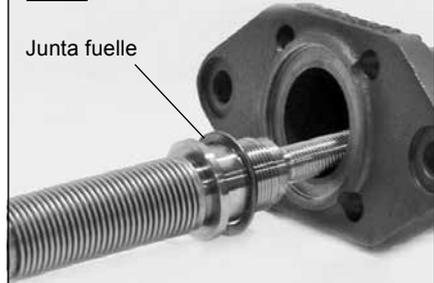
Asegurar que la superficie de la junta interna esté limpia antes colocar la nueva junta superior del fuelle por el vástago y encajando con cuidado el fuelle en la tapa.
