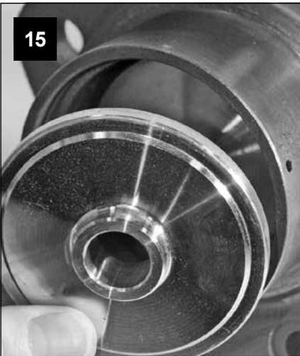
Volver a colocar el plato guía y el anillo de compresión.
