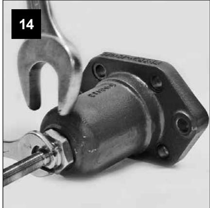
Sujetar el vástago del fuelle al volver a colocar la tuerca de sujeción.
