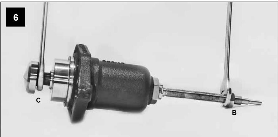
Volver a colocar el plato guía y enroscar un nuevo conjunto obturador en el vástago (a mano). Después apretar la tuerca **B** con una llave fija de 22 mm E/C y apretar la tuerca adaptador del obturador **C** con una llave fija de 24 mm E/C a un par de apriete de  $15 \pm 1$  N m para tamaños DN15 a DN20 y  $20 \pm 2$  N m para tamaños DN25 a DN2100.
