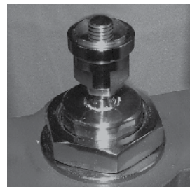
Fig. 18 Incorrecto - la rosca sobresale por la parte superior del adaptador
