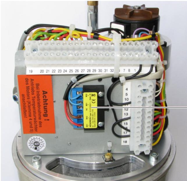
Placa de terminales del calefactor anti-condensación
