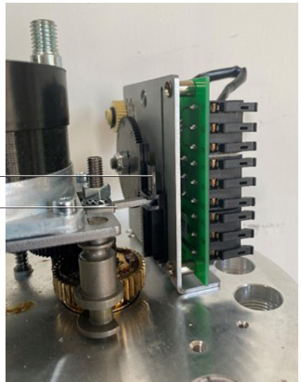
Fig. 8 Disposición de la retroalimentación del interruptor de recorrido auxiliar (WE) (1-6 kN)
