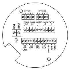
Fig. 23 ac wiring terminals
