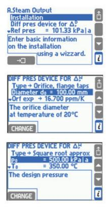
Orifice, flange taps Orifice - flange tappings
