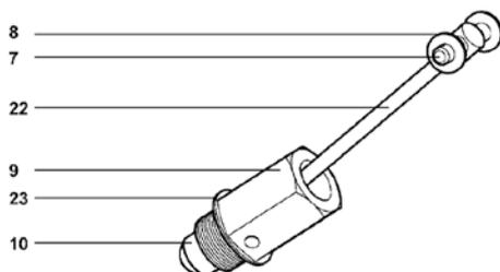
**F Dampfeinlassventil und Entlüftungsventil mit Ventilsitzen**
