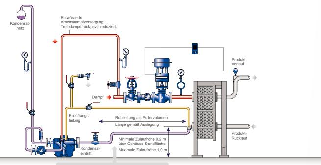
Die APT wird mit Schmutzfänger für Arbeitsdampfversorgung geliefert
