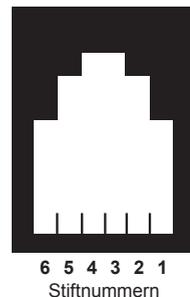
Bild 24 RJ11-Buchse
