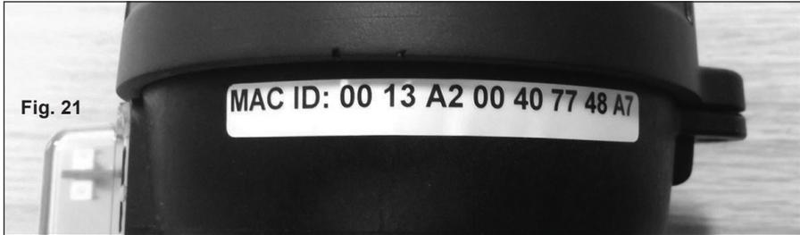
**Wichtig:** Sicherstellen, dass die MAC-ID zusammen mit zugehörigem Ableiter und Standort notiert wird. Diese Daten werden später für die Eingabe in die STAPS-Software benötigt (siehe untenstehende Copyright-Erklärung).
