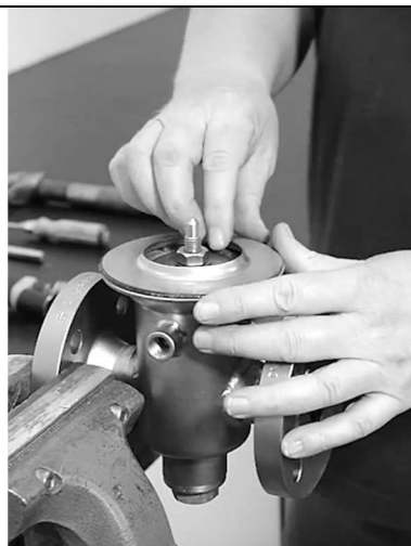
Abstandhalter (wenn eingebaut) entfernen.
