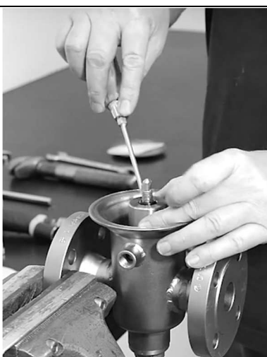
O-Ring #111 Ø 10,77 x 2,62 mm entfernen.
