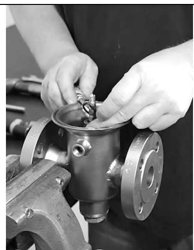
Kolben entfernen und O-Ring #116 Ø 18,72 x 2,62 mm entfernen.
