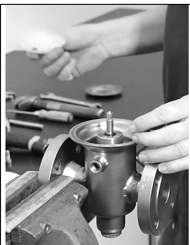
Federscheibe, Membranscheibe, Membrane und Schutzfolie (falls vorhanden) entfernen
