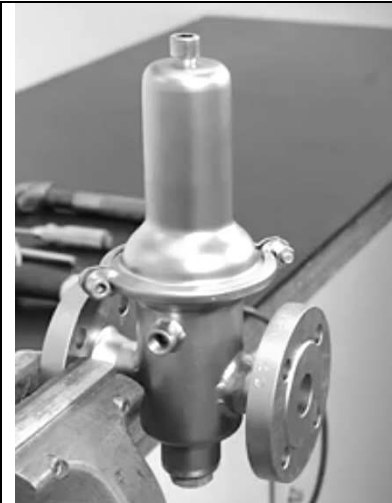
Ventilflansch, mit Federhaube nach oben, in einen Schraubstock spannen. Dazu Alu- oder Holzbacken verwenden.
