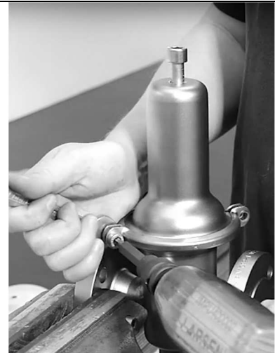
Profilschelle entfernen, dazu die beiden Schrauben und Muttern lösen.
