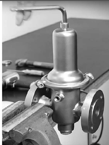
Feder vollständig entlasten, indem die Stellschraube gegen den Uhrzeigersinn gedreht wird.
