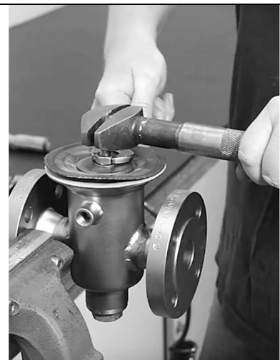
Kegelstange mit Verstell Schlüssel (Engländer) halten und mit Gabelschlüssel Mutter lösen und entfernen.
